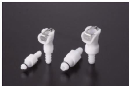
ワンタッチで分割、接合が出来、フューエルラインに割り込ませてガソリンタンクなどを取り外しが容易になります。分割時は本体の内蔵バルブとインサート側バルブが閉じるのでガソリンの流出を防ぎます。ダブルストッパータイプ。スペア Oリング 1ヶ付属。
