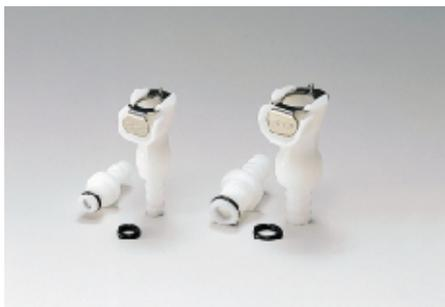
ワンタッチで分割、接合が出来、フューエルラインに割り込ませてガソリンタンクなどを取り外しが容易になります。分割時は本体の内蔵バルブが閉じるのでガソリンの流出を防ぎます。シングルストッパータイプ。スペア Oリング 1ヶ付属。
